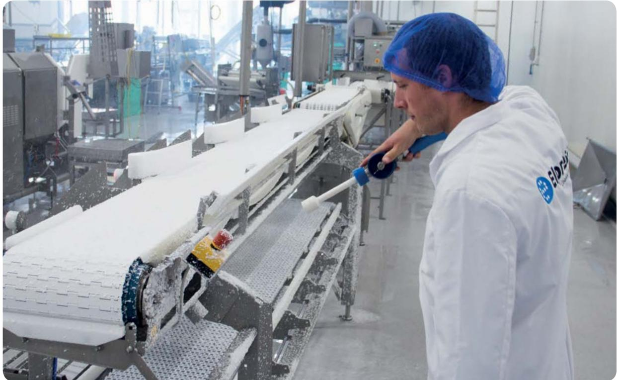
*La CF-Q 6E puede utilizarse simultáneamente por hasta 6 usuarios para el lavado con espuma.*
