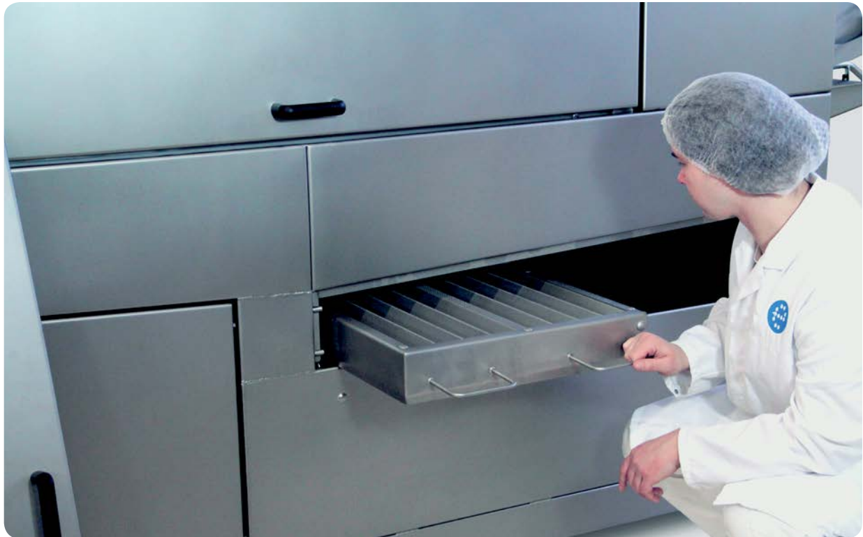
Der EKW-6000, die Filterschublade lässt sich leicht herausnehmen.
