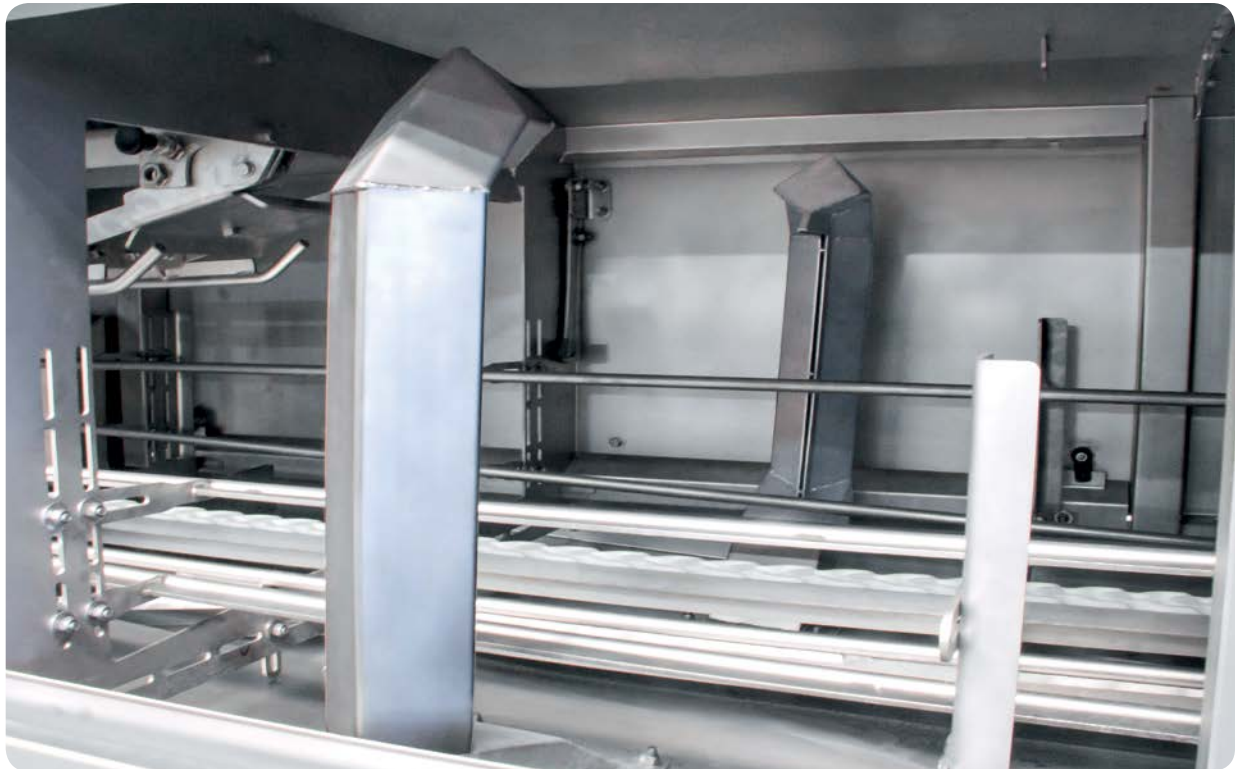
Der Innenraum des EAB-1-ST, das Restwasser wird von der Kiste abgeblasen.
