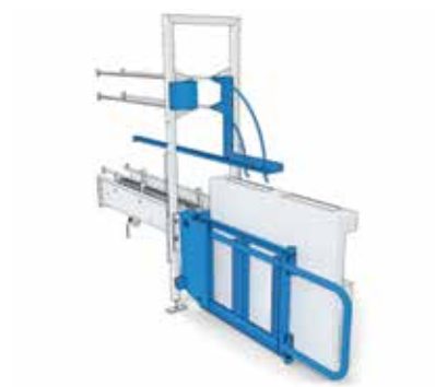
System wspomagania załadunku / rozładunku palet
