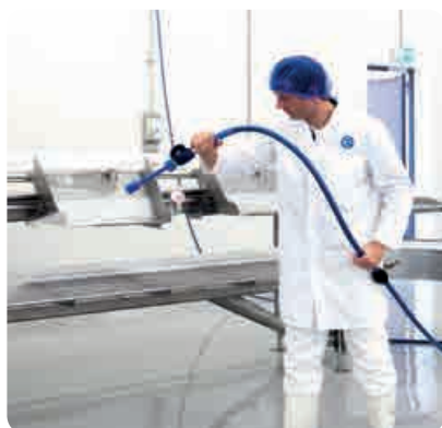
◀ Cleaning Mycie przy pomocy jednostki LDC-Q oraz zestawu ze zwijakiem węża
