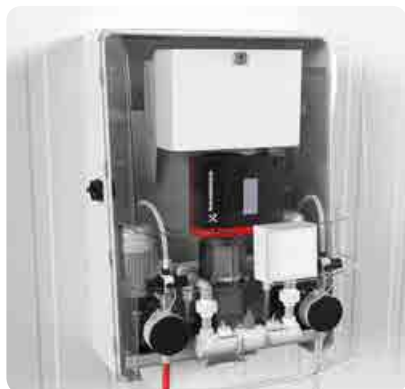
◀ CFD-Q zapewnia użytkownikom odmierzoną ilość środka do pianowania i środka dezynfekcyjnego
