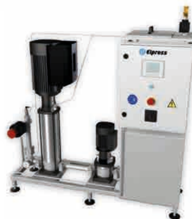
► Jednostka dostarczania ciśnienia MDC Mycie przy 40 Barach, do 16 użytkowników
