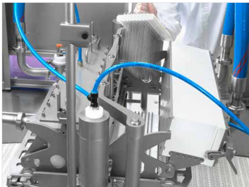
▲ De technologie van de GEA Multijector kenmerkt zich, naast een hygiënisch design, door een hoge naaldendichtheid.
